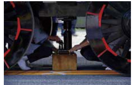
油圧ジャッキ 軽量・小型のため多く使用されている。
