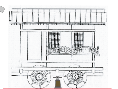
油圧ジャッキ 軽量・小型のため多く使用されている。
